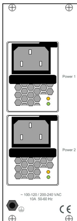
Рис. 2.34- Разъёмы питания для 4RU шасси 800Вт блоками питания переменного тока
