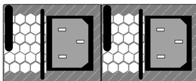
Рис. 2.39 Разъём питания 1RU шасси, модели XC5100 с источником питания переменного тока
