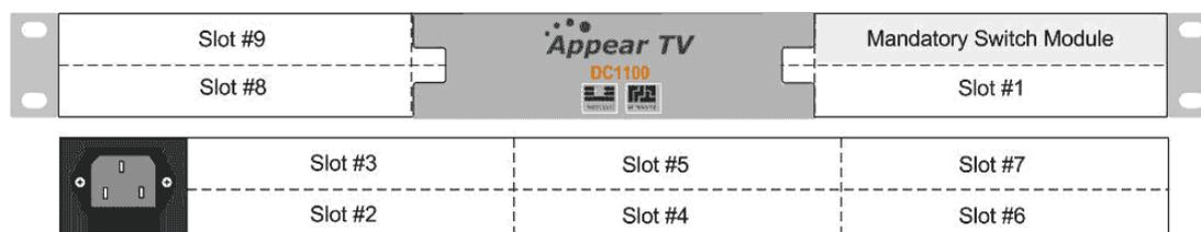
Рис. 2.31 - 1RU шасси с блоком питания, модулем коммутатора и доступными слотами модулей; вид спереди и сзади.
