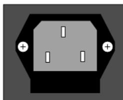
Figura 2.25 Conector de alimentación para el Chasis 1RU
