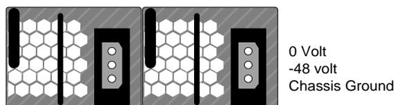
Figura 2.27 Conector de alimentación para el Chasis 1RU modelo XC5100, con modulo de alimentación de CD
