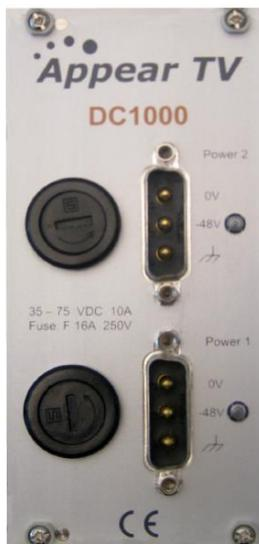
Рис. 2.35 - Передняя панель двойного блока питания 48В в шасси DC1000
