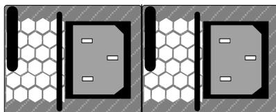
Figura 2.26 Conector de alimentación para el Chasis 1RU modelo XC5100, con modulo de alimentación de CA
