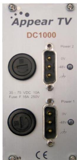
Figura 2.22 – Placa frontal de la fuente de alimentación de 48 V en un DC1000
