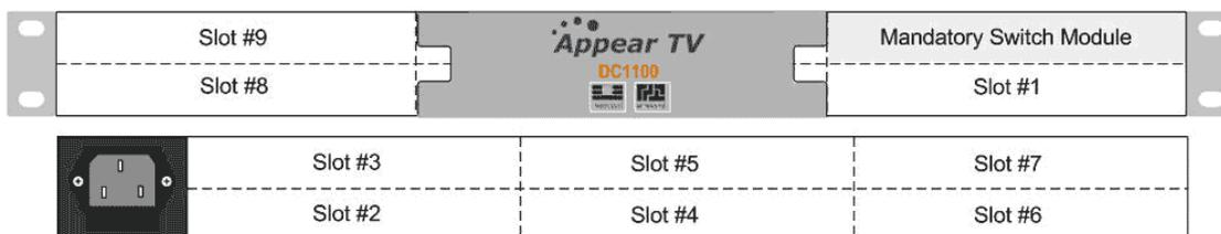
Figura 2.18 – Chasis 1RU con conectores de alimentación, módulo switch y ranuras disponibles; vista frontal y trasera.
