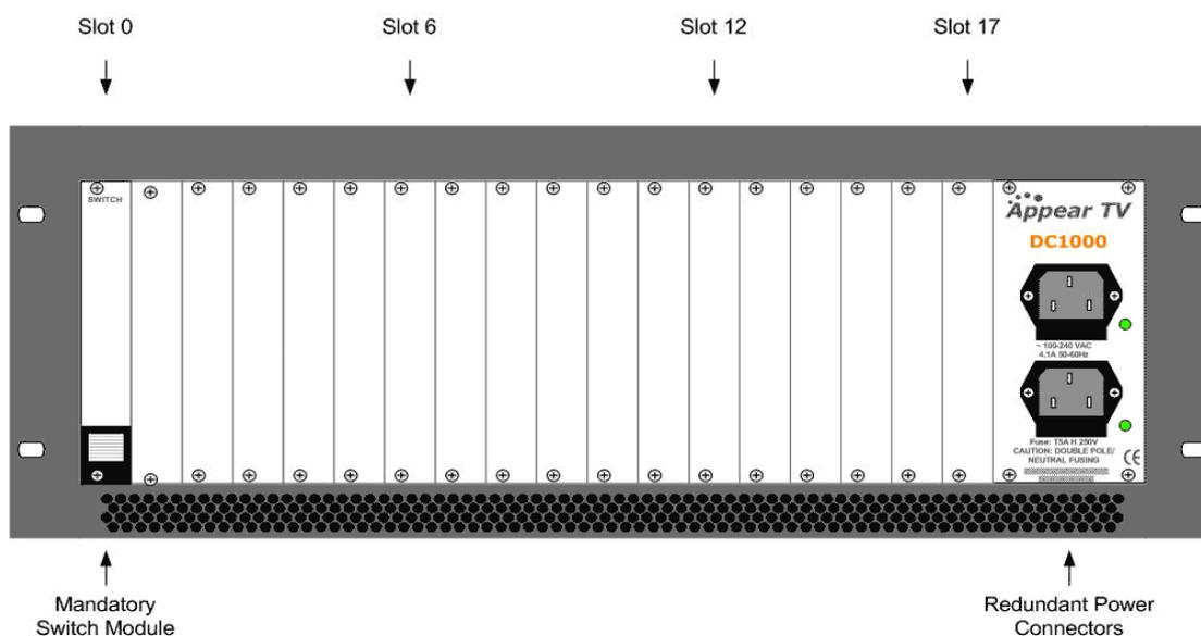
Figura 2.15– Chasis 4RU (DC1000/1001, SC2000/2001 and MC3000/3001) con conectores de alimentación, módulo switch y ranuras disponibles.
