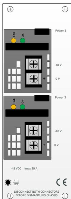
Figura 2.24 – Entrada de alimentación para chasis 4RU con 800 W de potencia de CC
