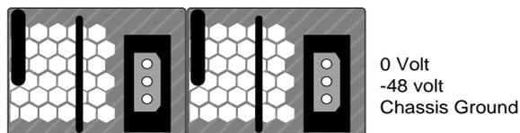
Рис. 2.40 Разъём питания 1RU наасси, модели XC5100 с источником питания постоянного тока
